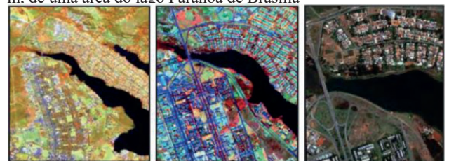
Figura 6 - Da esquerda para direita imagens do satélite Landsat 5 com resolução espacial de 30 m, Sport com 10 m e Ikonos com 1 m, de uma área do lago Paranoá de Brasília
